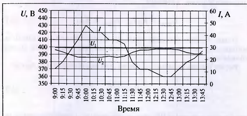
Рис. 4.2. Графики токов и напряжений, полученные по результатам измерений на ТП-206 и РП-200
